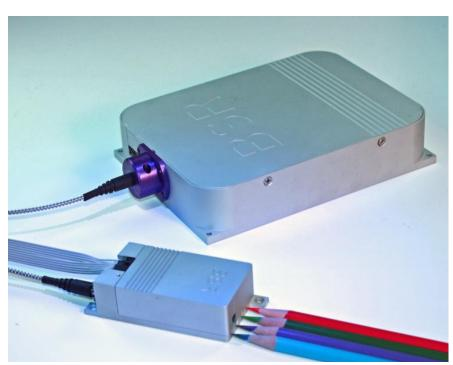
レーザーユニットは各波長のLD毎に温度制御され高い安定性を有しています。各波長毎に光レ ベルをセンシングしフィードバック制御します光レベルを安定動作します。ご関心の波長、光レ ベル、レーザータイプ、光コリメータ仕様等をご希望に合わせてご提供しますので、どうぞご相 談下さい。
